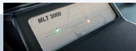
Дисплей для облегчения процесса регулировки фар. На светодиодной шкале отображается горизонтальное и вертикальное положения точки преломления светотеневой границы.
