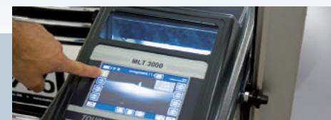
В доли секунды компьютер MLT 3000 анализирует контур светотеневой границы и выводит результаты измерений в табличном и графическом виде практически в режиме реального времени.
