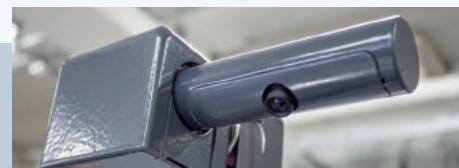
При установке позиционирующей камеры, характерные точки кузова автомобиля могут быть использованы для более точного позиционирования MLT 3000. Координатная сетка на цветном мониторе помогает точно позиционировать прибор перед автомобилем.
