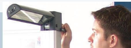
Выставление оптической оси прибора по отношению к продольной оси автомобиля производится при помощи зеркального прицела...
