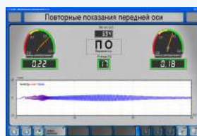
Амортизаторный тест Ясное графическое и цифровое представление измеренной информации.
