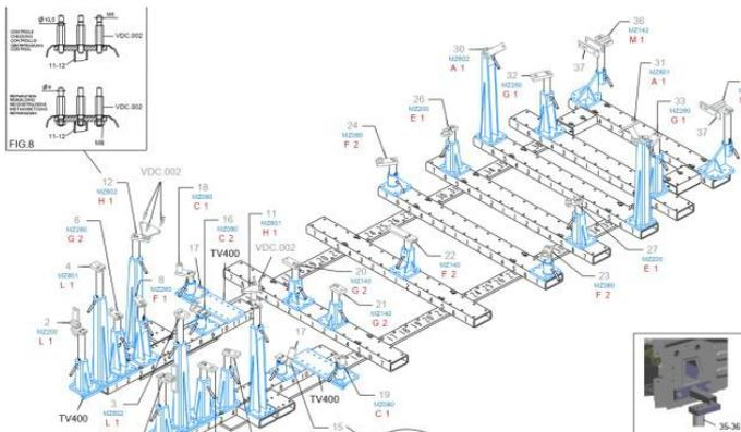
Для расстановки элементов системы MZ+ существуют наборы стапельных насадок контрольных точек кузова с доступом снизу, а также набор бокового портала, предназначенного для контрольных точек боковых и верхних панелей кузова.
