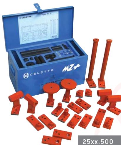
Набор ступенчатых насадок под кузов определенного автомобиля.
