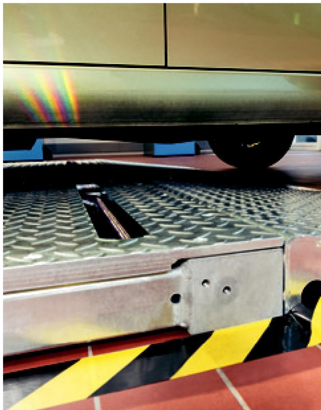
Низкопрофильный монтаж 80 мм (3,1")
