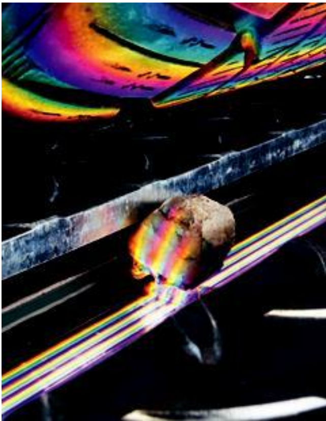
Небольшие объекты и грязь на шине не влияют на результаты измерения
