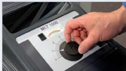
Прибор оснащен аналоговым люксметром и удобным регулятором для установки угла наклона светового пучка.
