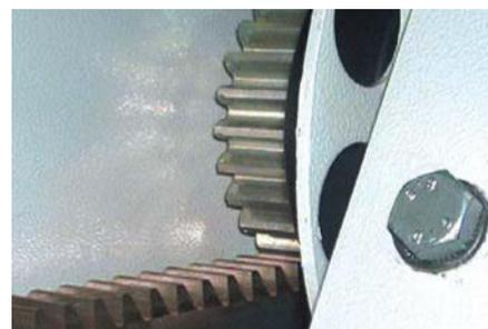
↑ Зубчатые стойки привода боковых щеток, работающих в тяжелом режиме.
