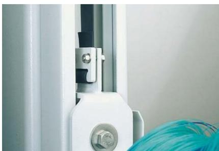
↑ Привод щетки крыши на плоских ремнях не требует высоких затрат на обслуживание.
