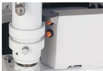
9 Бесконтактные датчики приближения контролируют положение щеток.
