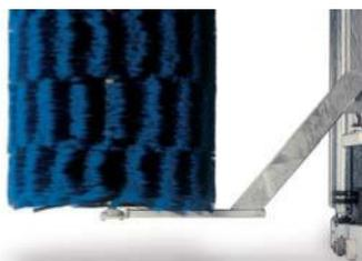
5 Боковые щетки, закрепленные в верхней и нижней точках на выдвигающихся кронштейнах, обеспечивают качественную и, в тоже время, бережную мойку.
