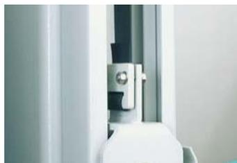
2 Необслуживаемый узел перемещения щетки крыши на плоском ремне.
